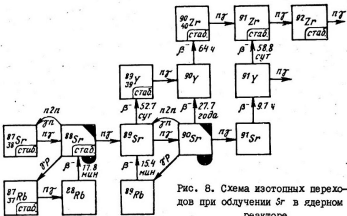
Рис. 8. Схема изотопных переходов при облучении  $^{90}\text{Sr}$  в ядерном реакторе
