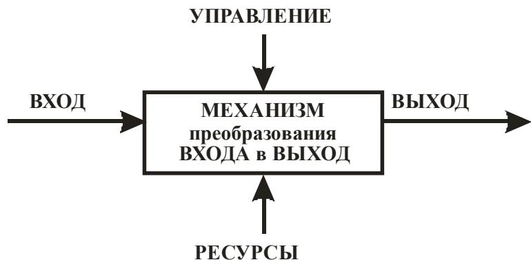
Рисунок 1. Модель функционирующей системы
