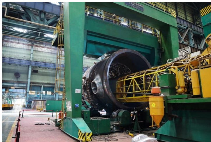
Рисунок 1 – Сварочная установка консольного типа
