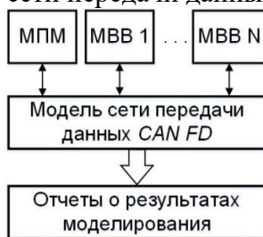
Рисунок 2 – Имитационная модель модульной ИИУС
