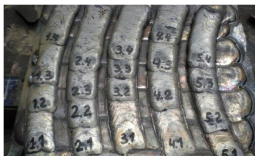
Рисунок 4 – Наплавка под флюсом с поперечными колебаниями электрода
