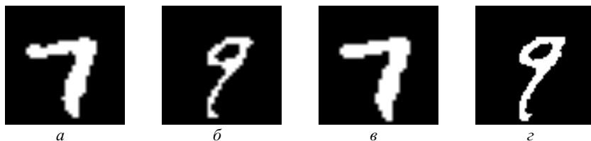
Рис. 1. Изображения, восстановленные нейросетью с цифровой голограммы (а, б), и оригинальные изображения (в, г)
