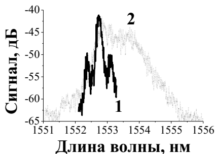
Рис. 2. Спектр отражения ОВ (200 об/мин): 1 – центральная жила (сплошная линия), 2 – боковая жила (пунктирная линия)
