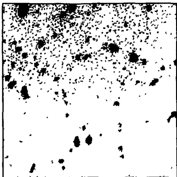
Рис. 17: Результат моделирования эволюции пор с помощью КА Изинга при P = 0.1
