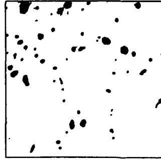
Рис. 9: Черно-белое представление микрофотографии для степени выгорания 42.6 GWd/tM
