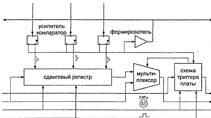
Рис. 2. Плата быстрого считывания данных с камер стримерных трубок.
