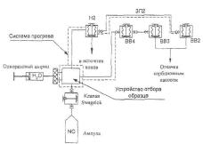
Рис. 4. Схема системы ввода NO в источник ионов масс-спектрометра
