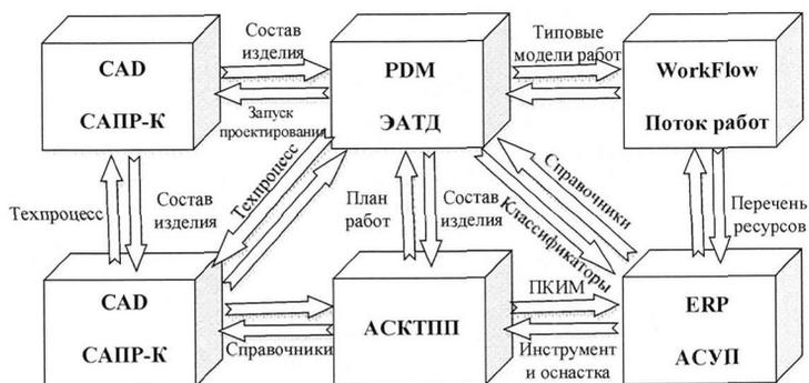
Рис. 12. Архитектура интегрированного решения по автоматизации процессов КТПП
