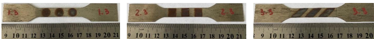
Рисунок 4 - Образцы с композитной структурой, полученные локальной лазерной обработкой.
