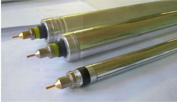
Рис. 13. ДТ сверху вниз: 30-мм алюминиевая, 30-мм лавсановая, 15-мм лавсановая
