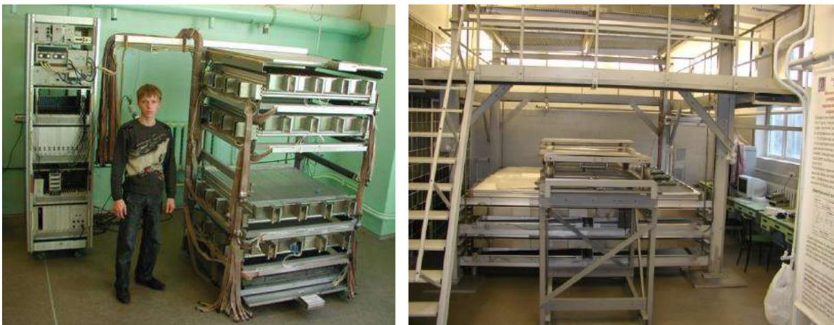
Рис. 21. Лабораторный макет (слева) и полномасштабный прототип (справа) мюонного томографа на космическом излучении
