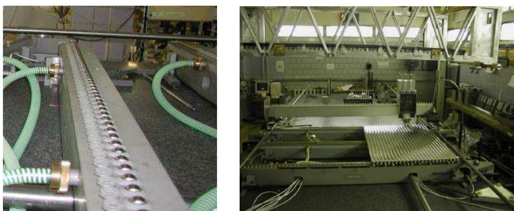
Рис. 5. Позиционирующая «гребенка» (слева) и клеераздаточная машина (справа)
