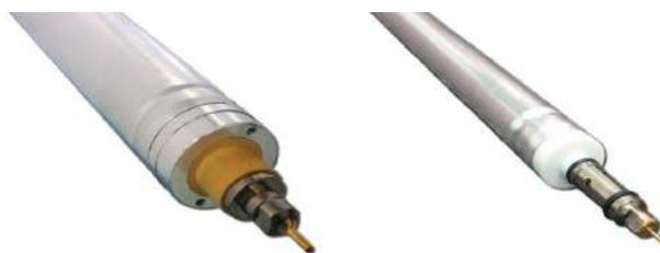
Рис. 26. Внешний вид MDT- и sMDT- трубок
