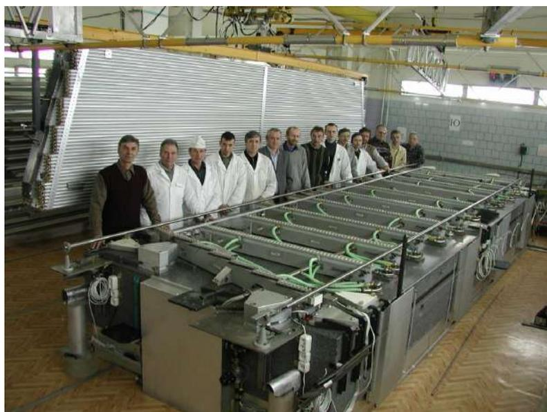
Рис. 2. Мюонная камера для детектора АТЛАС
