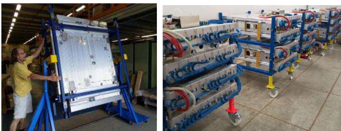
Рис. 29. sMDT- камеры в монтажно-транспортных рамах
