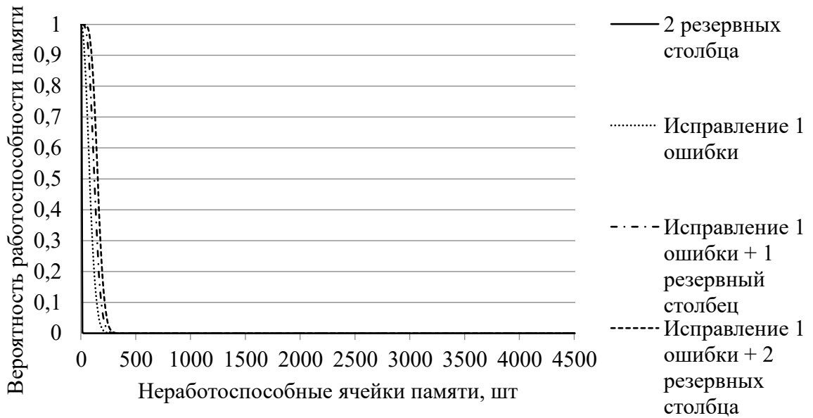
Рис. 6. Зависимость вероятности работоспособности памяти при использовании 4 способов повышения сбое- и отказоустойчивости блока СОЗУ для реализации Д
