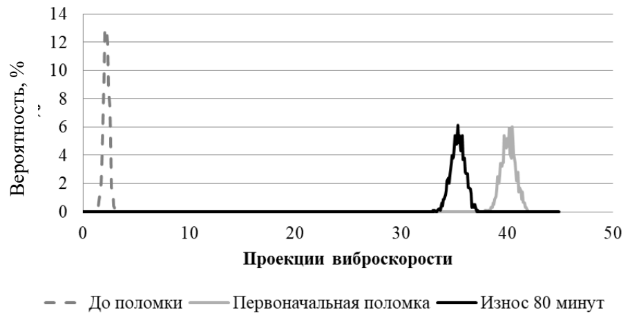
Рисунок 5 – Функции плотности распределения вероятности проекций сигналов вибрации
