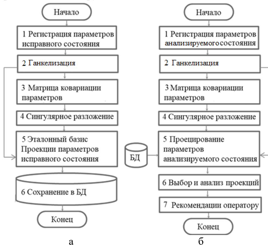
Рисунок 6 – Алгоритм модернизированного метода ССА при обработке диагностических сигналов: а) исправного оборудования (ретроспективная информация); б) текущая информация
