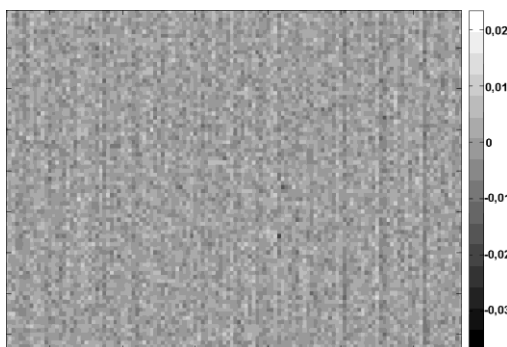
Рисунок 3 – Фрагмент портрета световых пространственных шумов синего цветового канала экземпляра камеры Canon EOS 400D. Светлые точки соответствуют пикселям, имеющим большую фоточувствительность, тёмные – меньшую
