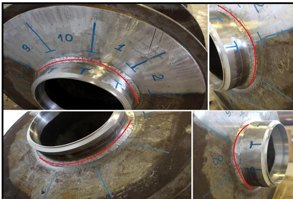
Рисунок – 13. Фрагменты корпуса проходки\_77\_АМЕ 1314.22.02.000. Красной линией обозначена продольная ось сварного соединения корпуса с диском.
