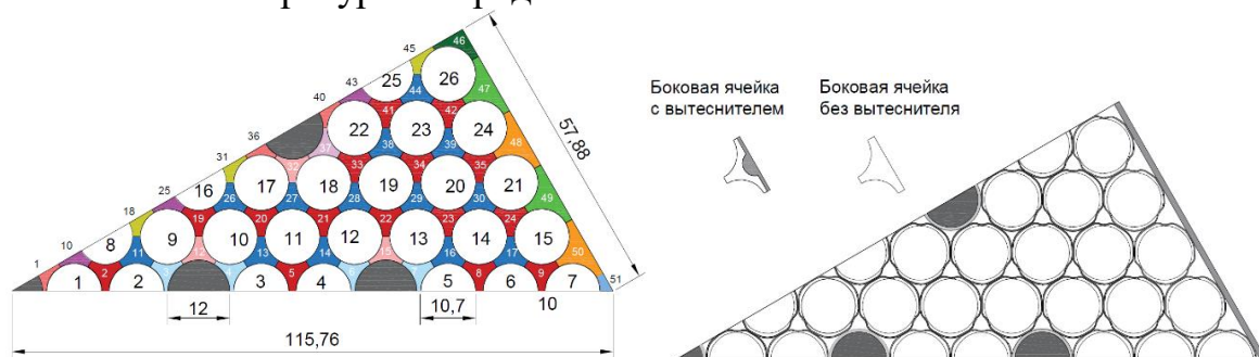
Рисунок 11 – Нодализация модель ТВС реактора ВВЭР-СКД и вариант дистанционирующей решетки
