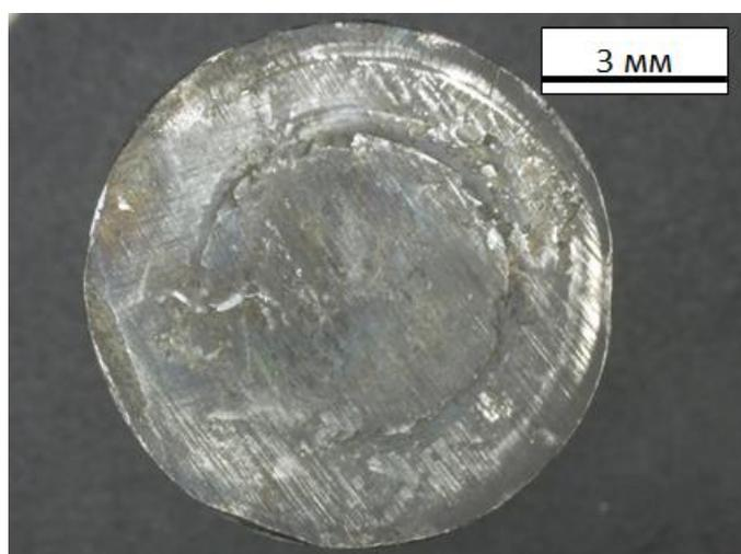
Рисунок 3 – Общий вид торца таблетки композиционного материала типа TiC в высокоуглеродистой высоколегированной чугуновой матрице.
