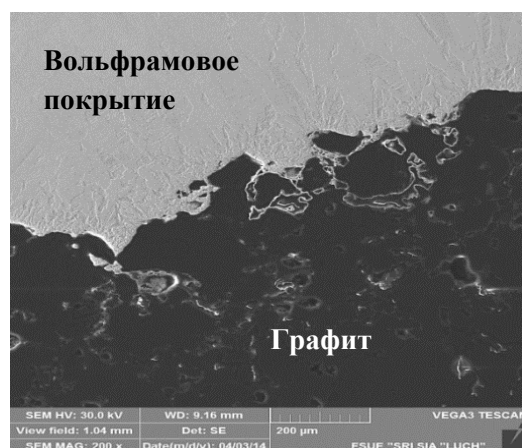
Рисунок 7 – Структура осажденного вольфрамового покрытия
