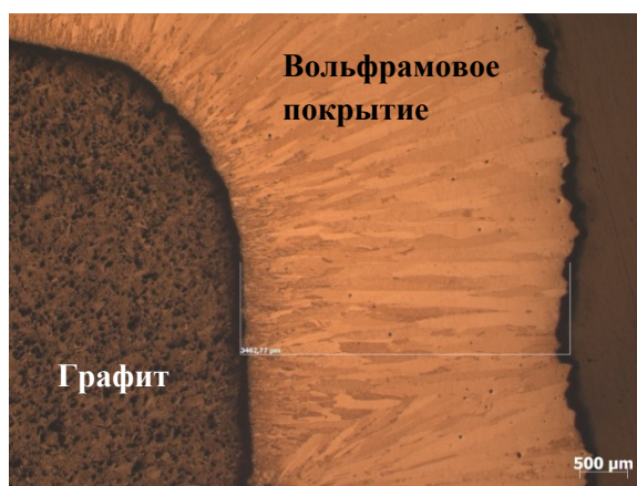
Рисунок 7 – Структура осажденного вольфрамового покрытия
