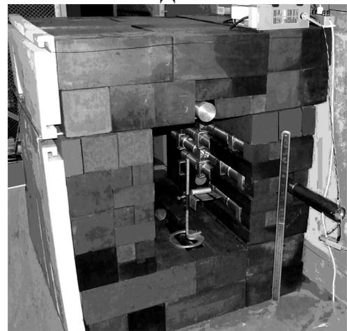
Рис. 16. Прототип установки таможенного обнаружения и контроля ДМ в аэропортах и схема расположения сцинтилляционных детекторов в нем.
