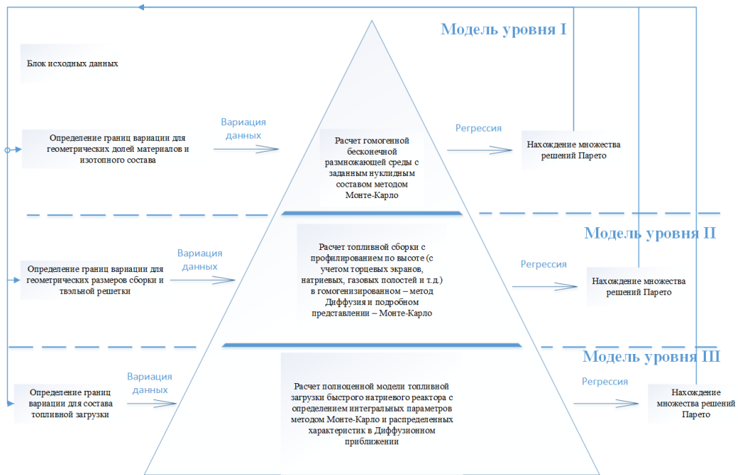
Рисунок 1. Итерационная схема последовательных трехуровневых (трехстадийных) решений оптимизационных задач.
