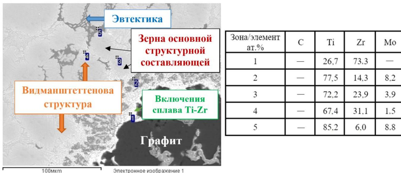
Рисунок 1 – Микрорентгеноспектральный анализ паяного шва соединения Мо/графит (порошковый припой Ti-48Zr-3Be (мас. %), режим пайки: 1100 °С, 20 мин)
