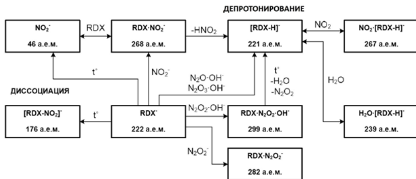
Рис. 20. Схема основных каналов перераспределения заряда в спектре гексогена.
