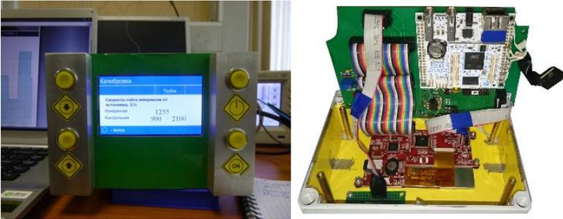
Рисунок 8 – Блок управления в режиме «Калибровка» и его вид изнутри
