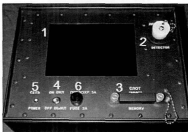
Рисунок 2 – Пульт НА «Баббл-дозиметр». 1 – ЖК-дисплей, 2 – гнездо для детекторов, 3 – слот для карты памяти, 4 – тумблер включения/выключения, 5 – индикатор питания сети, 6 – гнездо для предохранителя
