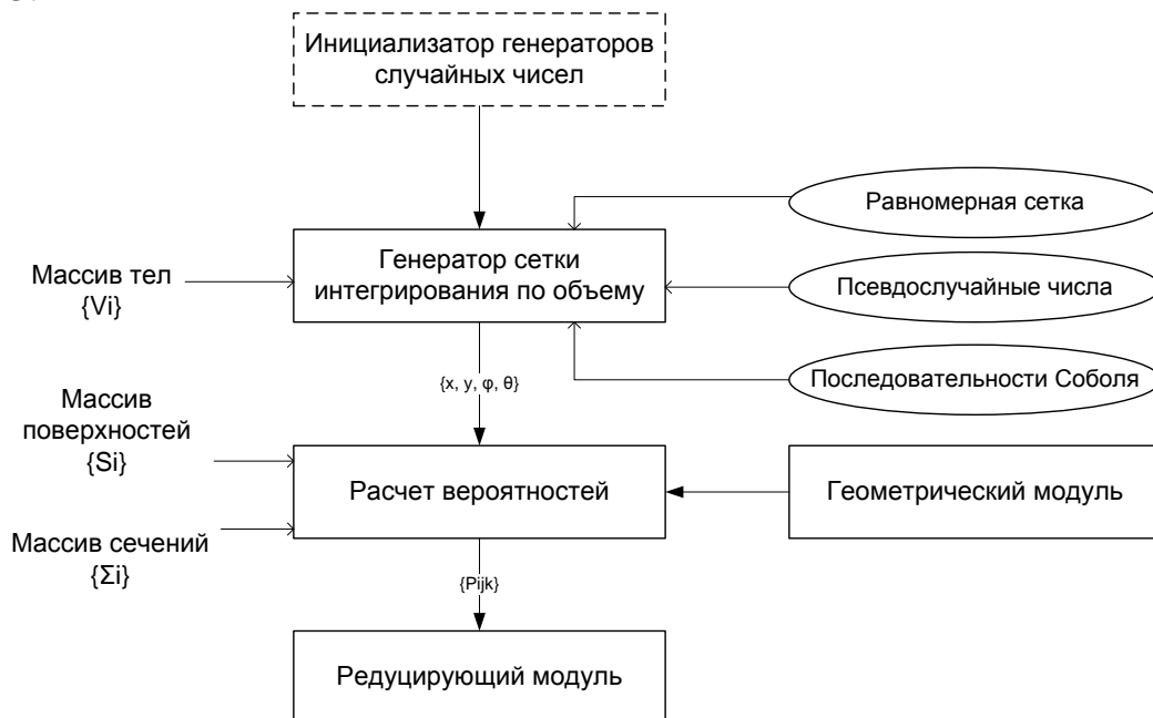
Рис. 3. Схема взаимодействия модулей блока расчета ВПС в произвольной 2D геометрии.
