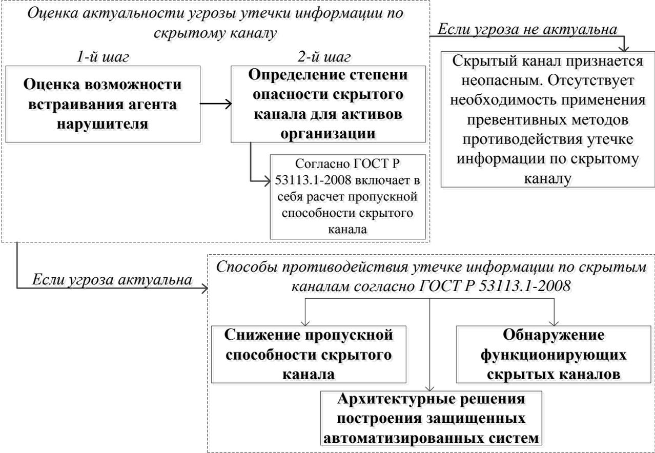
Рисунок 2 — Схема противодействия утечке информации по скрытым каналам
