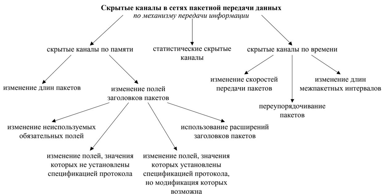
Рисунок 3 — Систематизация скрытых каналов в сетях пакетной передачи данных
