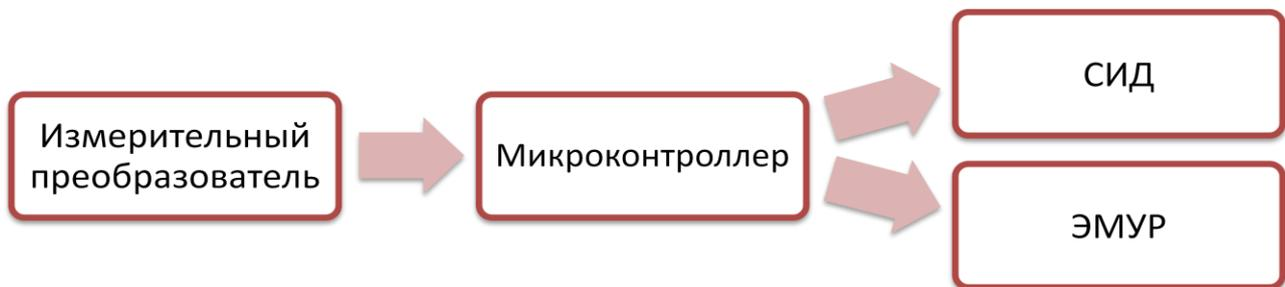
*Рис. 5. Структурная схема активной автоматической системы обнаружения подвижных объектов в «слепой» зоне боковых зеркал ТС.*
