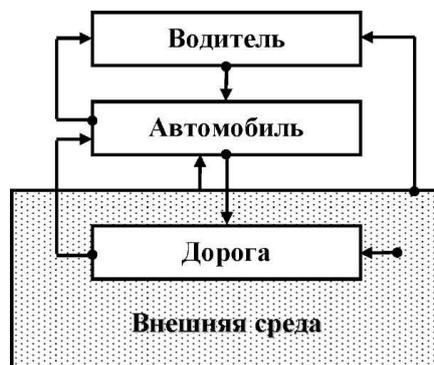
*Рис. 1. Структурная схема системы эксплуатации автомобильной техники*
