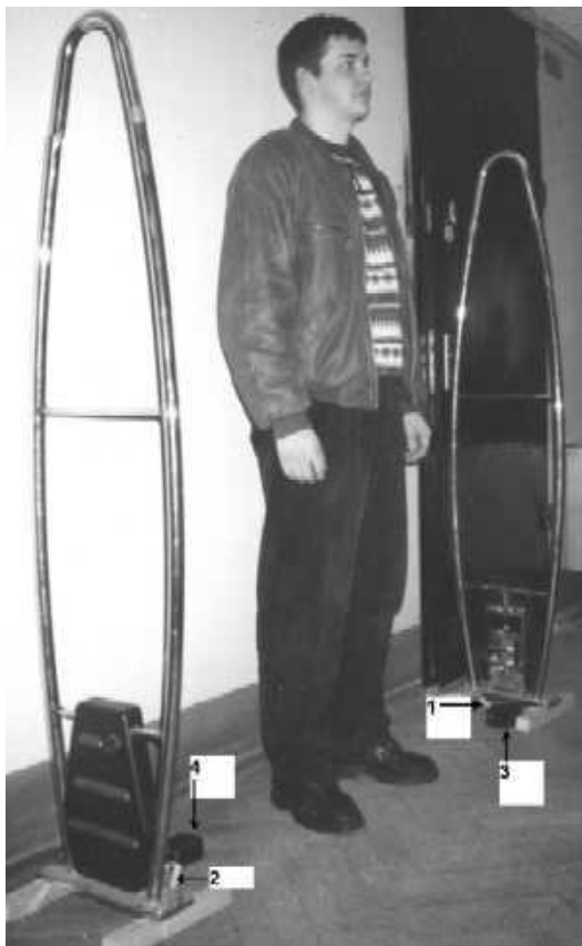
Рис. 3. Макет ДЭМ, встроенный в радиочастотную систему (1, 2 – передающая и приемная антенны ДЭМ, 3, 4 – передающий и приемный блоки ДЭМ)
