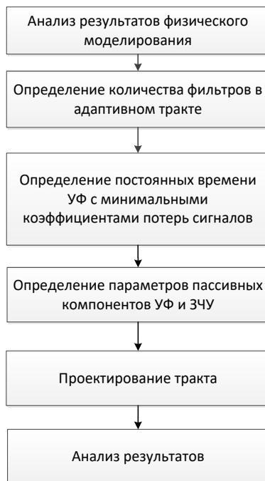
Рис. 7 Методика проектирования адаптивного тракта для считывания сигналов ГЭУ
