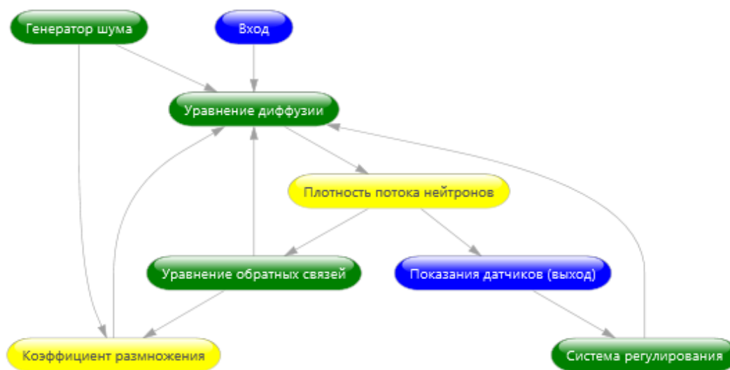
Рис. 1. Структурная схема математической модели реактора с обратными связями при случайных возмущениях в свойствах среды.
