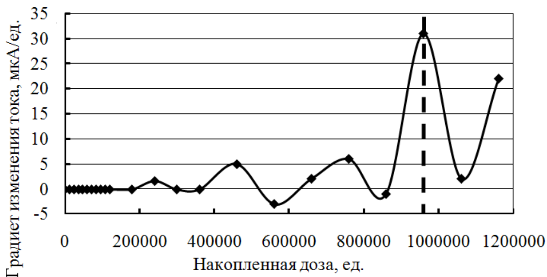
Рис. 4. Зависимость градиента изменения тока потребления МК 1887BE1У от накопленной дозы.
