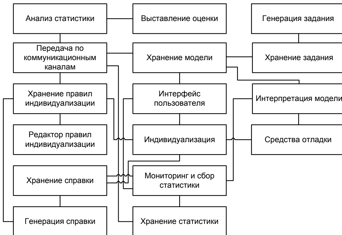
Рис. 2. Архитектура индивидуализированных языковых инструментальных сред поддержки обучения
