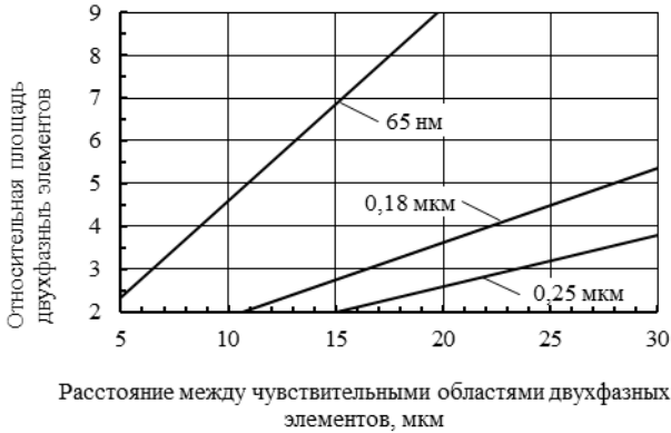
Рис. 15. Зависимость площади топологии двухфазных инверторов, нормированной на площадь однофазного инвертора, от усреднённой величины расстояний между МОП транзисторами одноимённого типа проводимости в различных конверторах для различных норм проектирования
