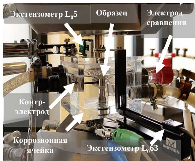
Рисунок 1 – Вид испытательной системы для исследования коррозионной усталости
