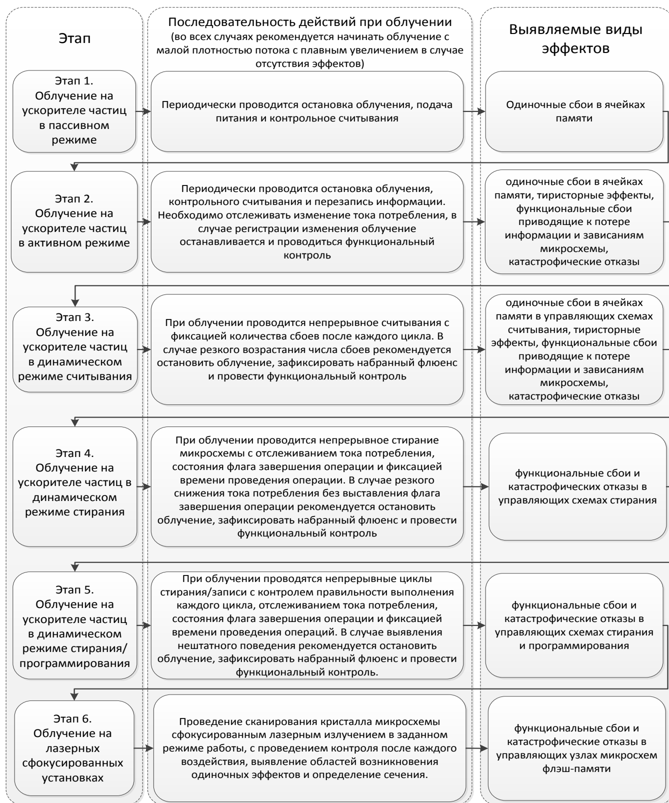
Рисунок 5 - Базовый алгоритм проведения исследований стойкости флэш-памяти к воздействию ОЯЧ по эффектам функциональных отказов
