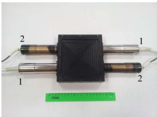
Рис.1.: Сцинтилляционный детектор системы «Наномаг». 1- ФЭУ-85 с МПЭ, 2- ФЭУ-85 без экрана
