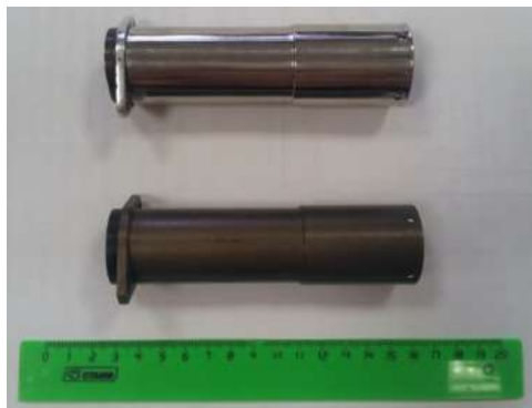
Рис. 1. Вид кожуха ФЭУ-85, покрытого магнитным экраном на основе многослойных пленочных структур (вверху) и без магнитного экрана (внизу).
