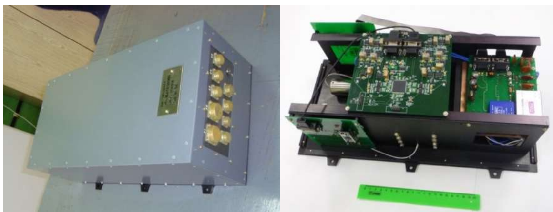
Рис 11. Общий вид и поблочная компоновка макета сцинтилляционной детекторной системы со снятым кожухом.
