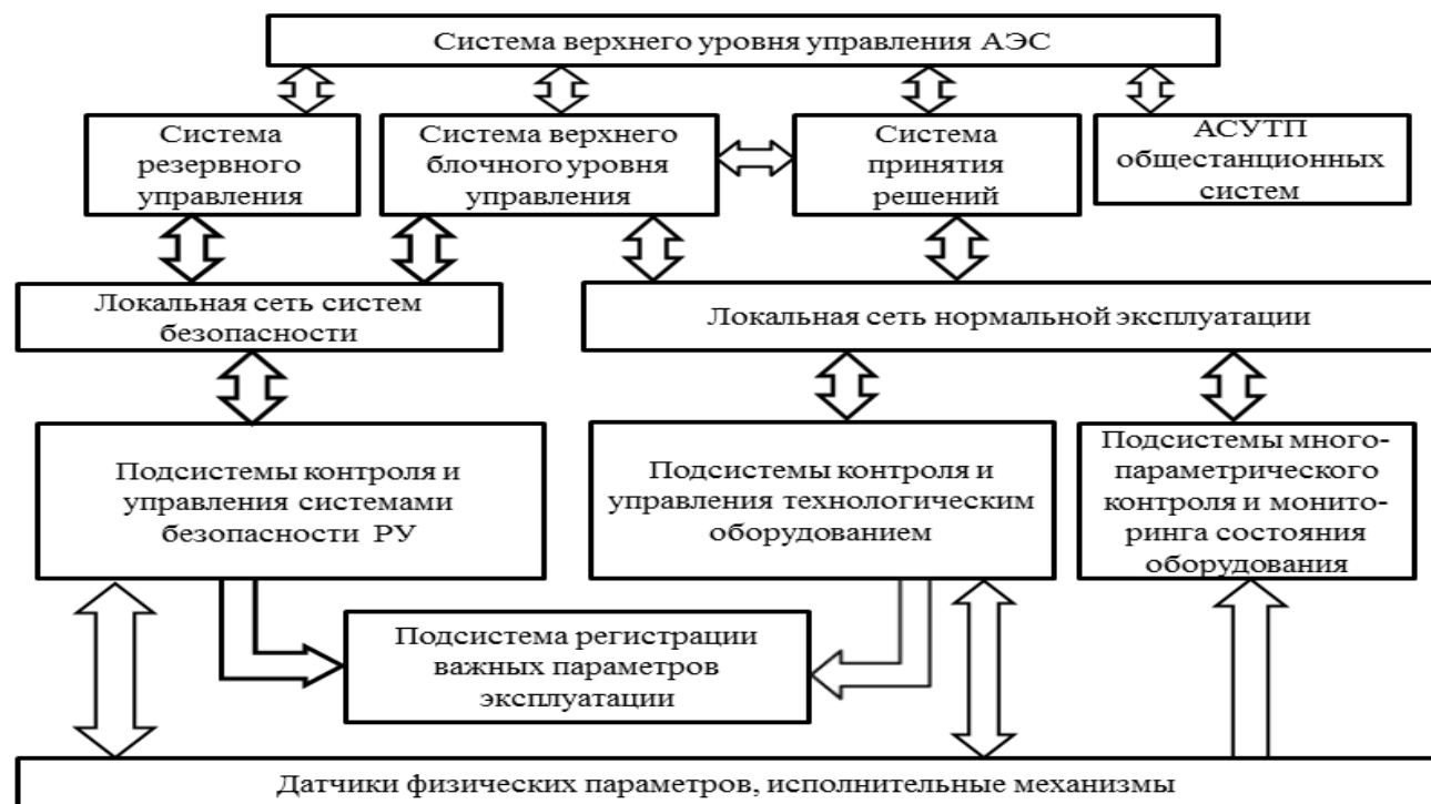
Рис. 1. Укрупненная структурная схема систем контроля и управления АЭС
