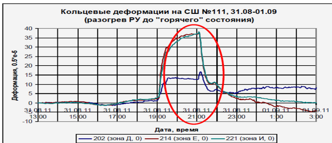
Рис. 14. Кольцевые растягивающие деформации в зоне СС №111 5ПГ-4 при разогреве РУ до «горячего» состояния
