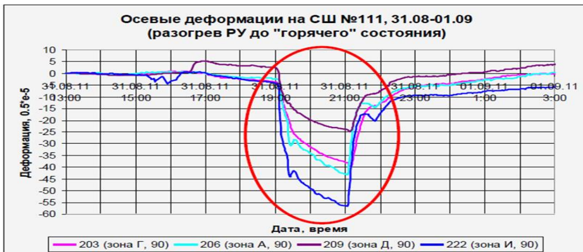
Рис. 13. Осевые сжимающие деформации в зоне СС №111 5ПГ-4 при разогреве РУ до «горячего» состояния
