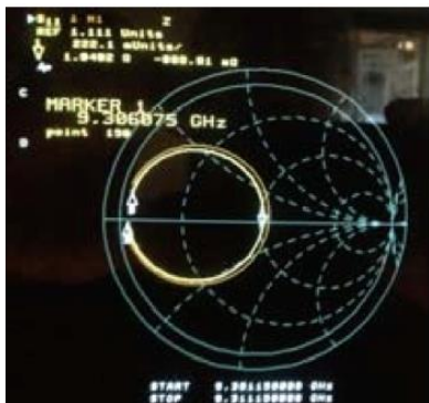
Рис. 4. Круговая диаграмма сопротивлений ускоряющей структуры
