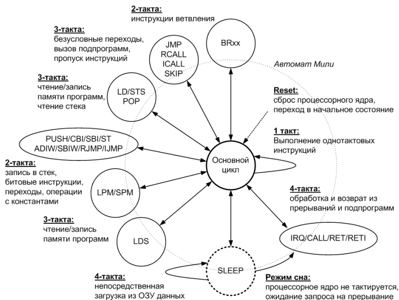
Рис. 6. Реализация ядра AVR на базе автоматов Мили и Мура
