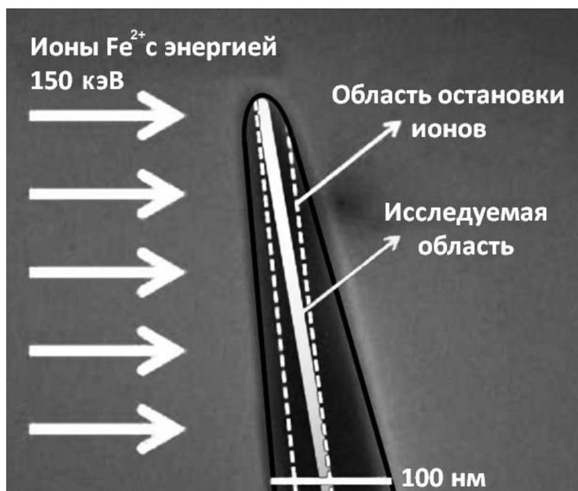
Рисунок 8 – Схема эксперимента по облучению образцов для атомно-зондовой томографии на примере облучения ионами  $\text{Fe}^{2+}$  с энергией 150 кэВ
