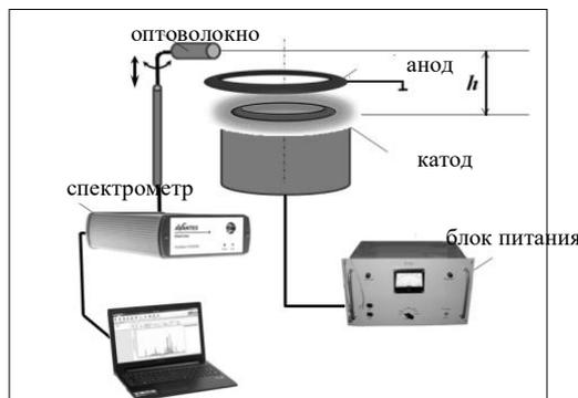
**Рисунок 2.** Схема эксперимента с магнетронным разрядом
