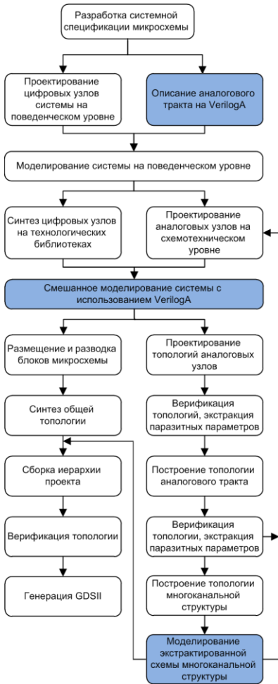
Рис. 8. Маршрут проектирования многоканальных микросхем считывания
