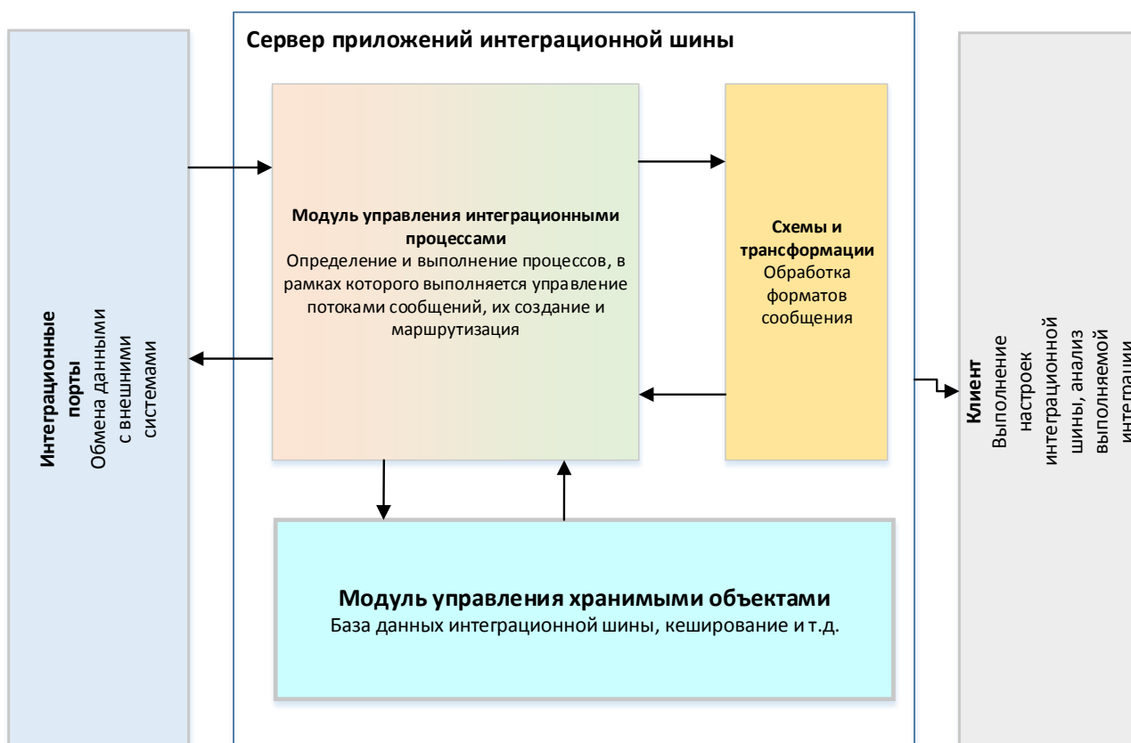
Рисунок 1 Архитектурные элементы модульной интеграционной шины
