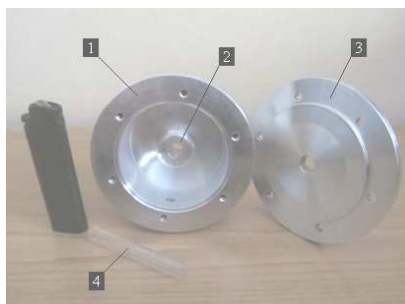
Рисунок 2 – Изготовленная резонаторная рабочая камера СВЧ-плазмотрона
