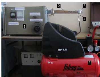
Рисунок 3 – Схема установки для экспериментального исследования СВЧ-плазмотрона на высоком уровне мощности
