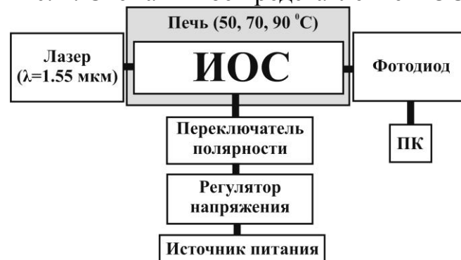
Рис. 3. Схема измерений дрейфа РТ
