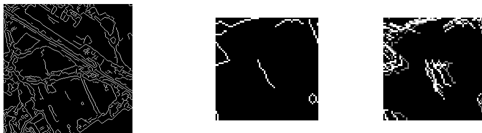
Рис. 8: Оконтуренное изображение сцены и увеличенные фрагмент сцены, использованный при построении КФ ЛФК и вещественная часть полученного фильтра.
