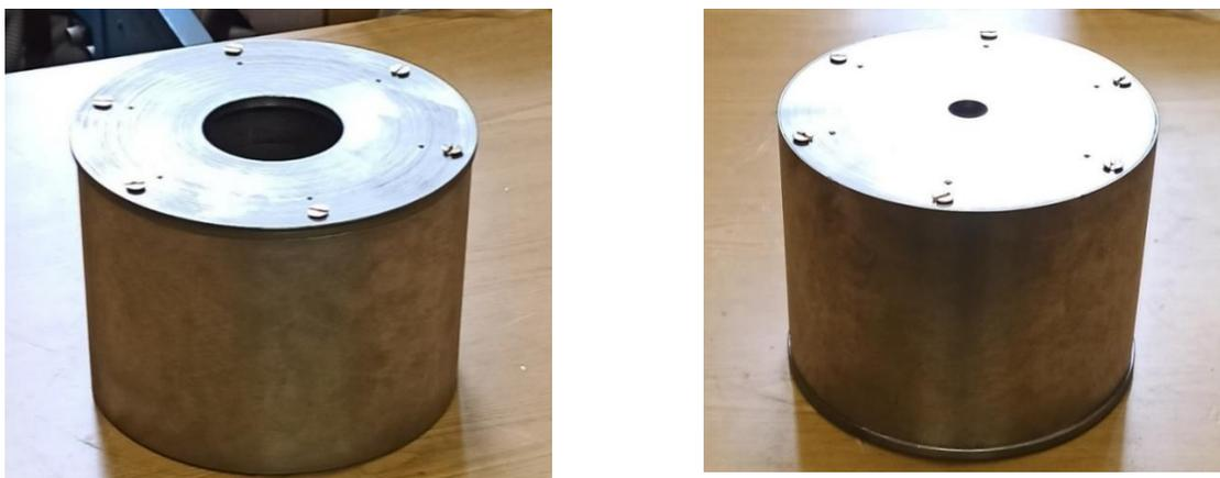
Рис. 13. Лазерно-плазменный ионный диод с магнитной изоляцией.
