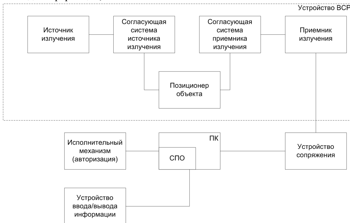
Рис. 4 – Схема структуры макета АПК аутентификации пользователей ИС по ИК изображениям сосудистого русла
