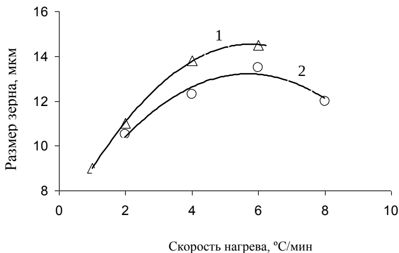
Рис. 2. Зависимость размера зерна топливных таблеток в зависимости от скорости нагрева:
