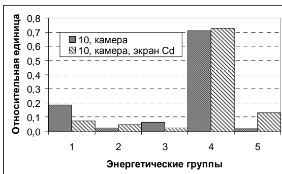
Рис. 8. Восстановленные энергетические распределения потока нейтронов методом ИНС ( R = 10 см).
