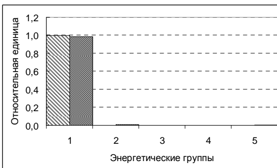
Рис. 2. Исходные (левые столбцы) и восстановленные распределения потока нейтронов (правые столбцы) для (а) источника ^{252}\text{Cf} и (б) источника ^{238}\text{Pu-Be} методом ИНС.
