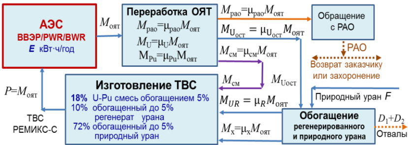
Рисунок 6. Схема материальных потоков и их обозначения в замкнутом РЕМИКС-ЯТЦ для тепловых реакторов.
